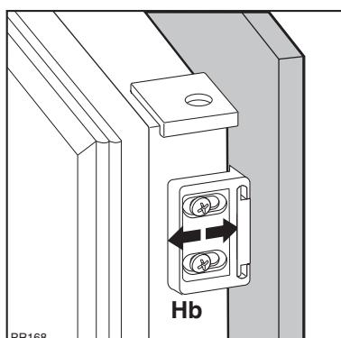
Установите крышку (Hd) на направляющую (Hb) так, чтобы она защелкнулась.
