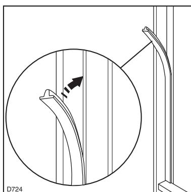
Установите крышки (C-D) в стыки и отверстия под петли.
