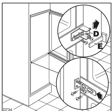
**После перевешивания дверцы на другую сторону убедитесь в том, что все винты затянуты надлежащим образом, а магнитная прокладка прилегает к шкафу холодильника. При низкой температуре в помещении (т.е. зимой) прокладка может вначале неплотно прилегать к шкафу холодильника. В этом случае дождитесь естественной усадки прокладки или ускорьте этот процесс, нагрев ее с помощью обычного фена.**
