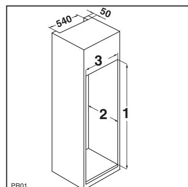
Установите прибор в выемку для встраивания таким образом, чтобы он прилегал к внутренней поверхности кухонного шкафа с той стороны, с которой у него установлены петли дверцы.
